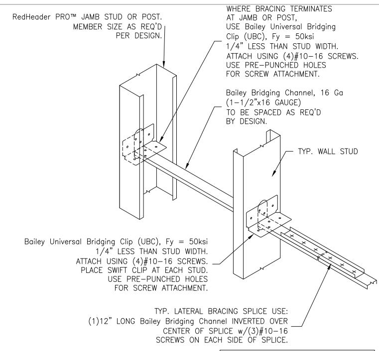
THIS DETAIL IS NOT RECOMMENDED FOR WALL STUDS DEEPER THAN 8"
